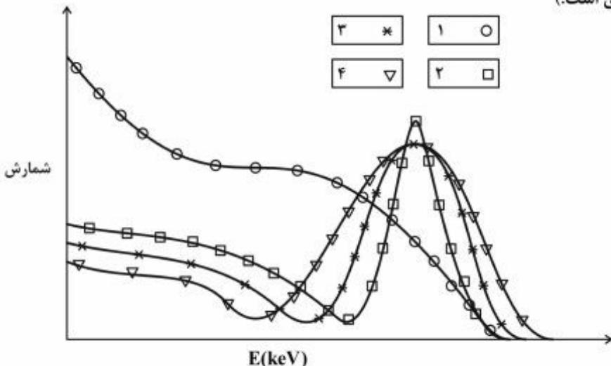
$\text{BaF}_2 : ۴ - \text{NaI}(\text{Tl}) : ۳ - \text{NE}102\text{A} : ۲ - \text{LaBr}_3 : ۱$  (۱)
