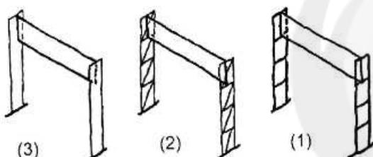
(۱) نیروهای داخلی گشتاورهای خمشی، نیروهای برشی - نیروهای داخلی محوری - نیروهای داخلی گشتاورهای خمشی و نیروهای برشی و نیروهای محوری
