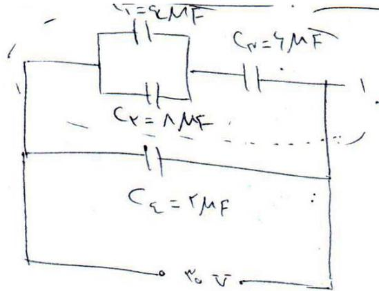
ظرفیت معادل مجموعه به روش زیر به دست می آید. چون  $C_1$  و  $C_2$  با مجموعه  $A$  موازی است و مجموعه با  $C_3$  سری است.
