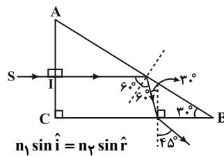
پرتو SI با زاویه تابش  $60^\circ$  که از زاویه در نتیجه بازتابش کلی رخ می‌دهد و با زاویه تابش  $30^\circ$  که از زاویه حد کمتر است به وجه BC می‌تابد. قانون شکست نور را برای آن می‌نویسیم:
