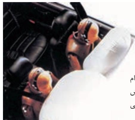
شکل ۱۴ باد شدن سریع کیسه‌های هوا هنگام برخورد شدید خودرو ناشی از انجام یک واکنش سریع شیمیایی است که طی آن حجم زیاد ولی کنترل شده‌ای از گاز نیتروژن تولید می‌شود.
